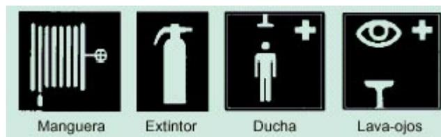
**Figura 6: Señalización de seguridad**
