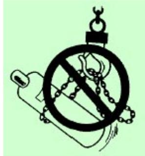
Figura 42: Indicador de prohibición de utilización de cadenas o cables para transportar botellas de gas.
